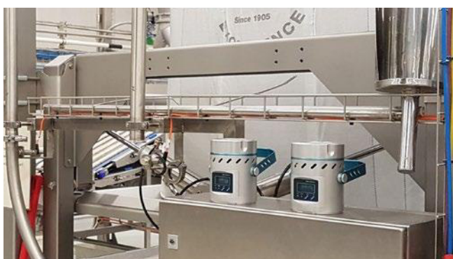
Erfassung des Hygienrisikos „Luft“ durch Luftkeimsammler
