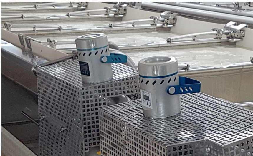
Erfassung Hygienrisiko Luft durch Luftkeimsammler
