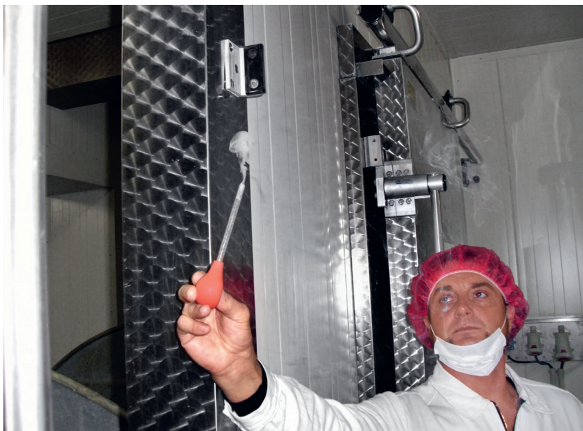
Visualisierung der Luftströmungen zwischen unterschiedlichen Hygienebereichen
