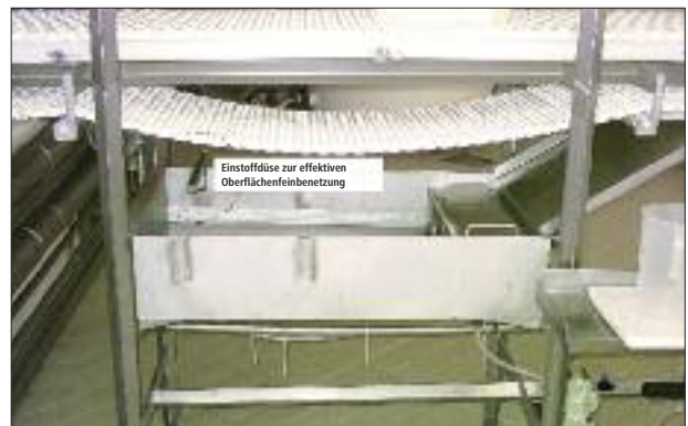
Das Entkeimungsmittel wird mittels einer mit Druckluft betriebenen Dosierpumpe über eine spezielle Einstoffdüse von unten feinst auf die Bandoberfläche gesprüht
