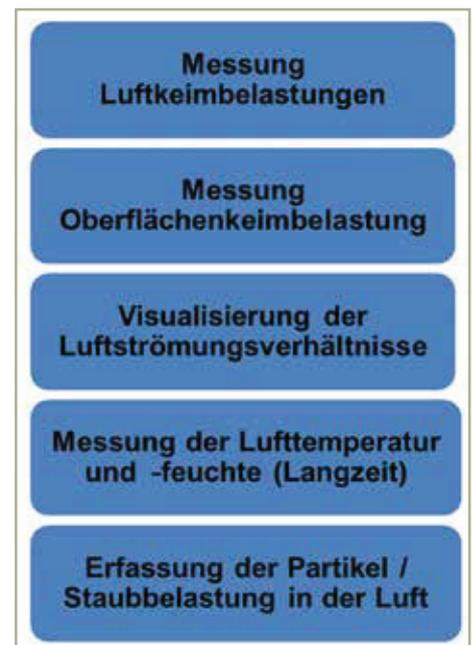
Abb. 2: Analyseverfahren zur Durchführung einer Hygiene – klimatischen Prozessumfeldanalyse nach Just in Air®.
