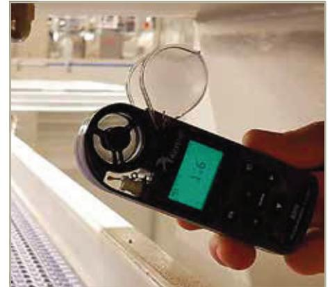
Abb. 5+6: Visualisierung der Luftströmungen und messen der Luftgeschwindigkeit zwischen unterschiedlichen Hygienebereichen.
