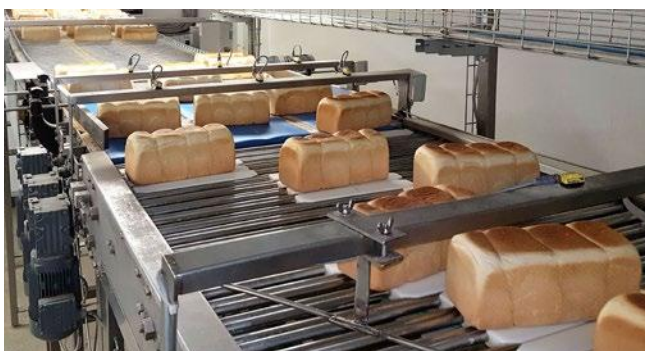
Toastbrote im Einlauf zum Bereich Schneiden und Verpacken
