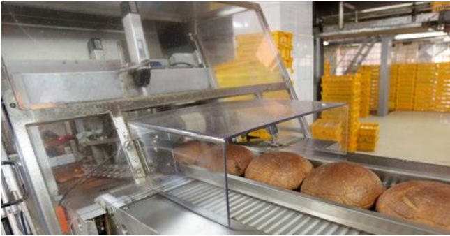
Weizenmischganzbrote im Einlauf in die Verpackungsmaschine
