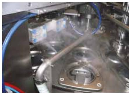
Hygienisierung von Luft und Oberflächen im Abfüll- & Verschleißbereich.
