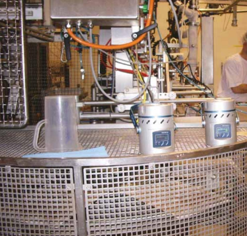
Unverzichtbar: Die Messung der Luftkeimbelastung ist ein wichtiges Element bei der Ermittlung des Ist-Zustandes der Betriebe.
