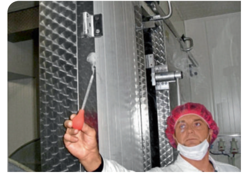
Abb. 4: Die Messung der Luftströmung unter Berücksichtigung unterschiedlicher Druckverhältnisse gehört zur Charakterisierung des Prozessumfelds.
