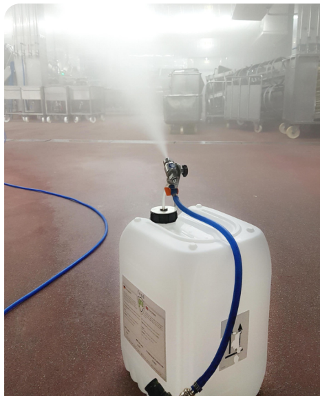
Vernebelung der nachhaltigen Hygienetechnologie „food-protect“ in einem Verarbeitungsraum Foto: DOEPMANN und ÖHLMANN
