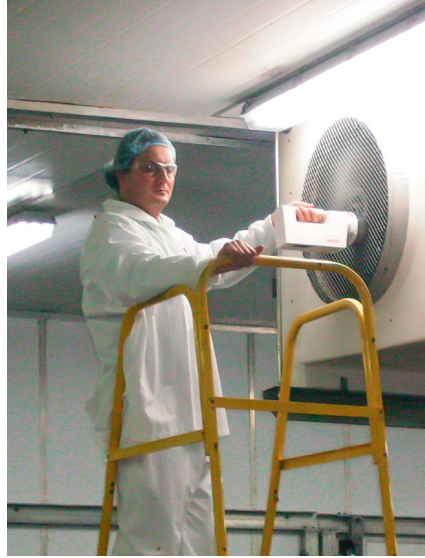
Erfassung der Keimbelastung aus/ in den Umluftkühlern. / Recording the bacterial load from/ in the recirculating coolers.
