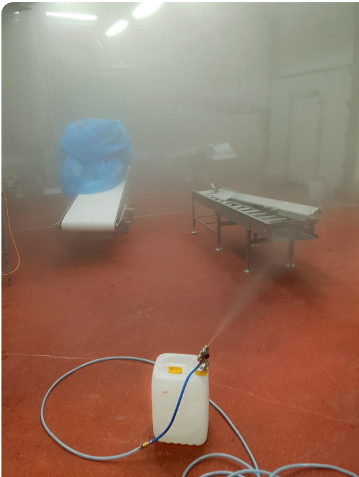
Abb. 4: Alle Oberflächen innerhalb des Prozessbereichs, von produktberührenden Teilen bis hin zu Einbau-Peripherie, werden gleichzeitig einer Desinfektion unterzogen. Foto: Just in Air GmbH
