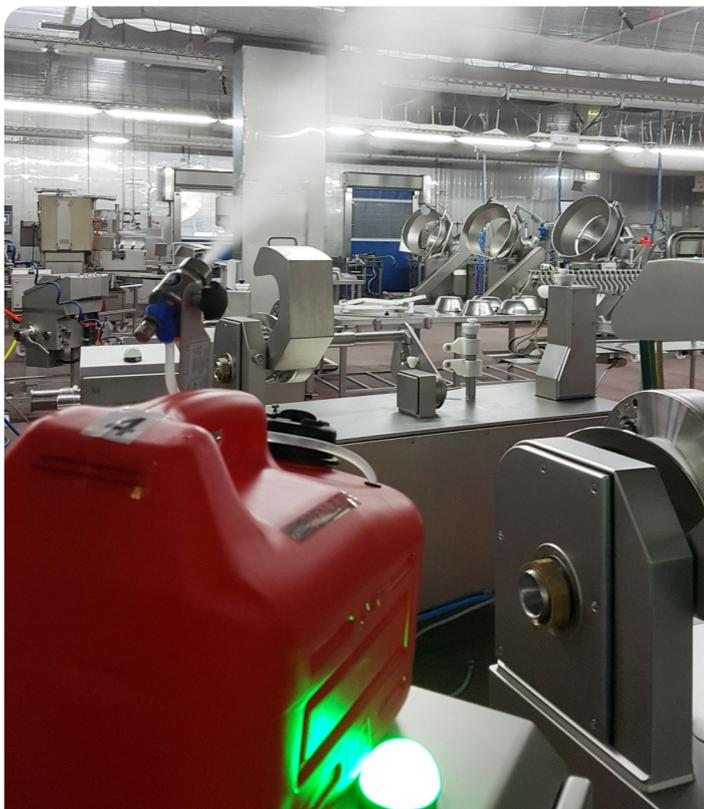
Das Kaltnebelprinzip mit Druckluft-Zweistoffdüsenteknik gewährleistet die vollständige Abdeckung aller Oberflächen im Raum, wodurch auch die Lebensmittelsicherheit verbessert wird. Foto: Ohlmann
