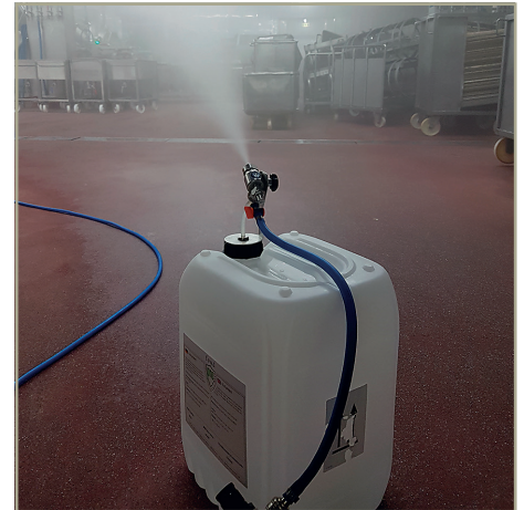
Abb. 8: Vernebelung im Verarbeitungsraum.
