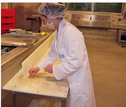
Das Hygienierisiko von Oberflächen wird durch Oberflächenkeimmessungen ermittelt.
