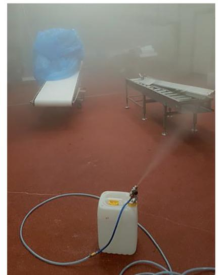
**Abb. 8** Mobile Zweistoffdüsen – Verneblereinheiten im Raum Zerlegung I
