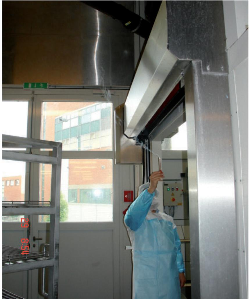
**Abb. 1 Visualisierung der Luftströmungsverläufe**
