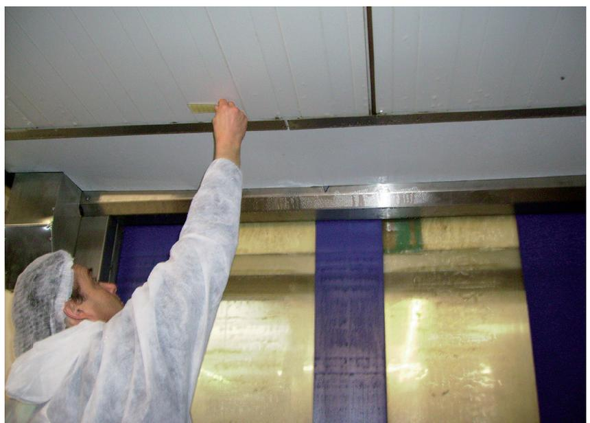
**Abb. 2 Hygienische Kontrolle der Oberflächen an der Decke im Kühlraum (Kondensattropfen als Kontaminationsrisiko)**
