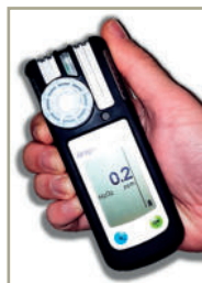
Abb. 18: Messung des Wasserstoffperoxid-Gehaltes in der Raumluft mittels Dräger X-am 5100.
