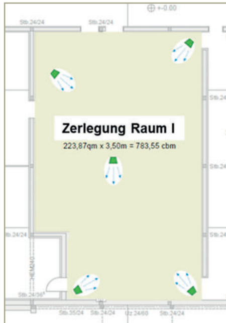
Abb. 4: Positionen und Ausrichtung der Deckeldüsen bei der Stoßentkeimung in Zerlegung Raum I.
