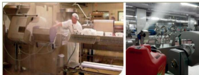
▲ Einsatz der Zweistoffdüsenteknik als mobile Einheit Deckeldüse in der Füllerei.
