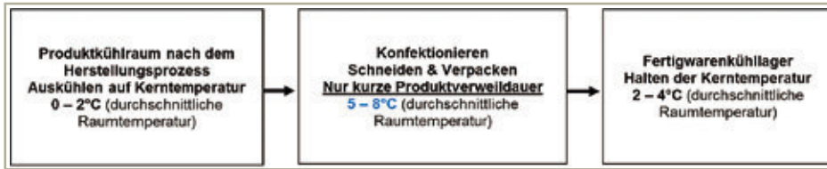
Darst. 1: Prozessablauf mit den durchschnittlichen Raumtemperaturverläufen für gekühlte Produkte tierischer Herkunft.
