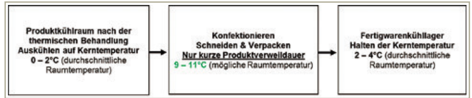
Darst. 4: Möglicher Raumtemperaturverlauf für gekühlte Produkte tierischer Herkunft.
