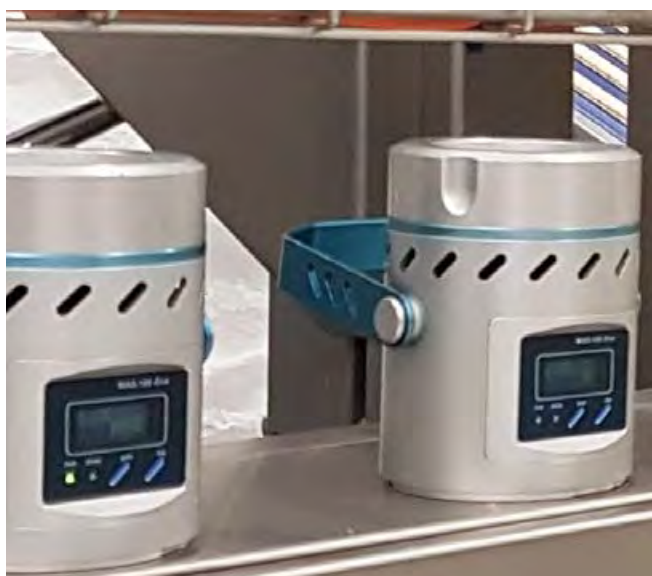
++ Luftkeimmessungen im Sauberraum
