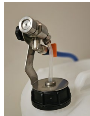
Abb. 3: Aufbau einer Zweistoffdüse zur Vernebelung
