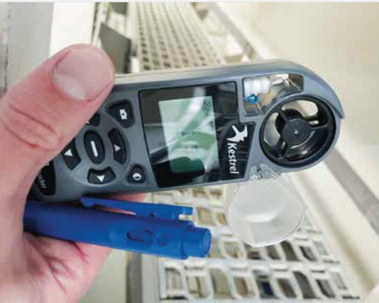
Abb. 3: Visualisierung und Messung der vorliegenden Luftströmungsverhältnisse
